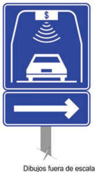
**Figura IX-33. Ejemplo de SIS-70 PAGO CON TELEPEAJE, utilizada como señal previa de carril de pago exclusivo con tablero adicional con flecha**
