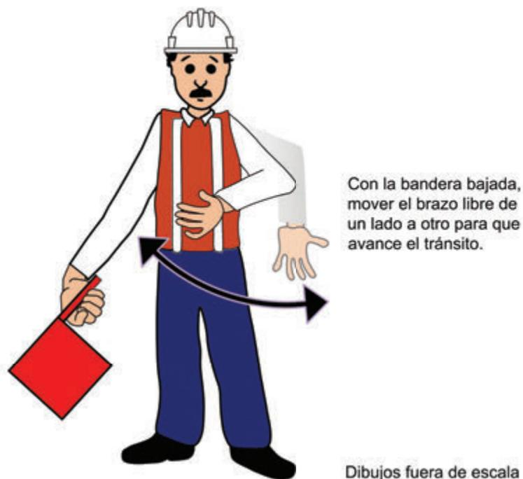
**Figura VI-14. Posición del banderero para indicar al tránsito detenido que puede avanzar, con la bandera**
