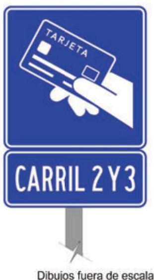
**Figura IX-30. Ejemplo de SIS-69 PAGO DE CUOTA CON TARJETA y tablero adicional indicando carriles**
