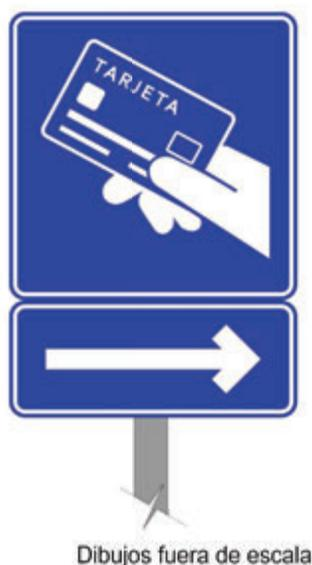
**Figura IX-31. Ejemplo de SIS-69 PAGO DE CUOTA CON TARJETA y tablero adicional con flecha**
