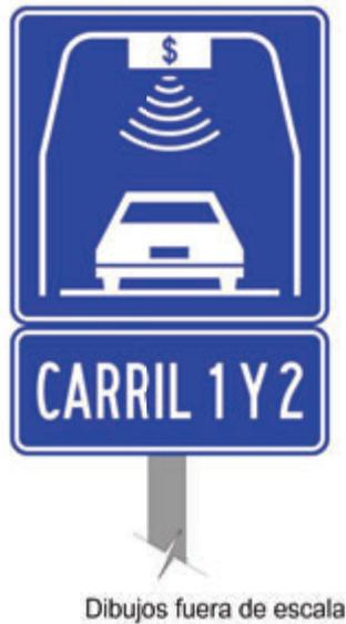
**Figura IX-32. Ejemplo de SIS-70 PAGO DE CUOTA CON TELEPEAJE con tablero adicional indicando carriles**
