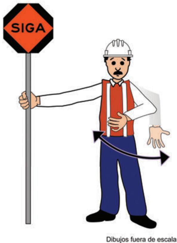
**Figura VI-11. Posición del banderero para avanzar el tránsito con la señal ALTO/SIGA**
